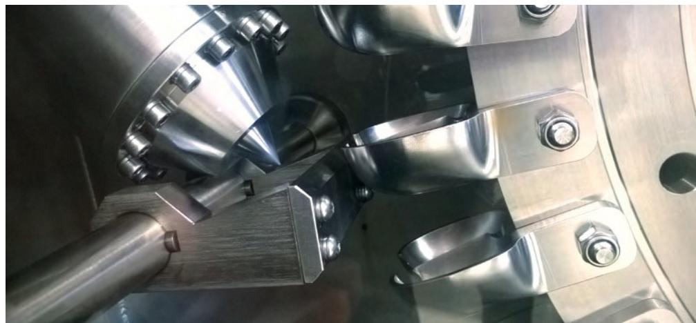
bínu bývá i několik desítek kilometrů dlouhý tlakový přívaděč, který představuje velké riziko tlakového rázu. Změny průtoku musejí být velmi pomalé i z důvodu rizika zvýšení usazeného kalu v potrubním systému. Peltonova turbína je optimálním řešením s ohledem na rovnотlaký (akční) typ turbíny, protože při výpadku napájení generátoru neovlivňují otáčky průtok.
